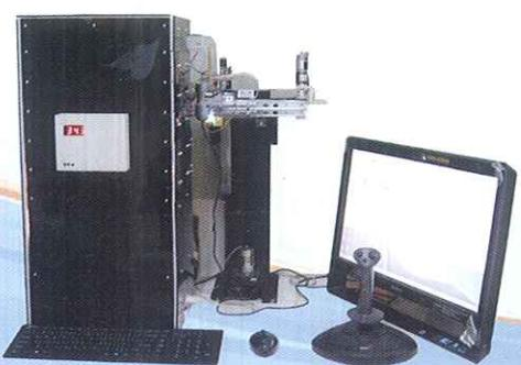
**AutoMODS** คือ ระบบอัตโนมัติสำหรับเพาะเลี้ยงเชื้อวัณโรคด้วยอาหารเหลว ซึ่งสามารถให้ผลการจำแนกเชื้อและทดสอบเชื้อดื้อยา ในเวลาเดียว กัน โดยให้ผลการเพาะเชื้อในเวลาใกล้เคียงกับวิธีมาตรฐาน ระบบการทำงาน ประกอบด้วย 1) กล้องจุลทรรศน์ดิจิตอล (Digital Microscope) 2) Three Axis moving 3) ตู้อบ 37 ° C 4) คอมพิวเตอร์ และซอฟแวร์ 5) หลอดบรรจุอาหารเพาะเชื้อชนิดเหลว (Liquid media in "TUBE")
